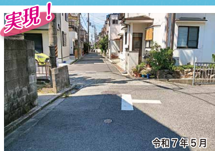
松原市天美東4丁目231-31付近 交通量の増加に対応し、安全対策として交差点マークを設置し、地域の交通安全を向上させました。
